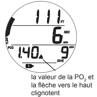
ALARME PO 2 DÉCLANCHÉE (au cours d'une alarme sonore)
